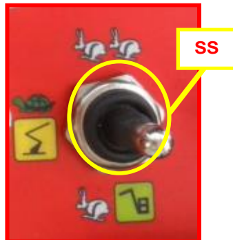
Afbeelding 22: keuzeschakelaar snelheid op afstandsbediening.
