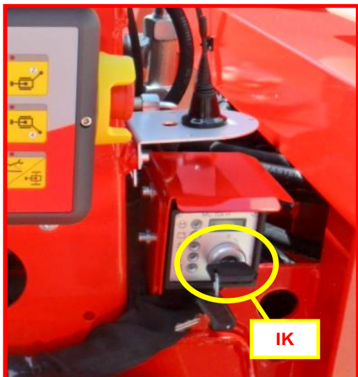
Afbeelding 4: bedieningspost voor start/stop motor.
