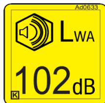
Afbeelding 83: signalering geluidsniveau van de machine.
